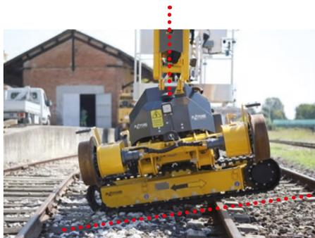
**La potenza** è erogata attraverso un motore endotermico diesel da 10,5 KW di potenza.
